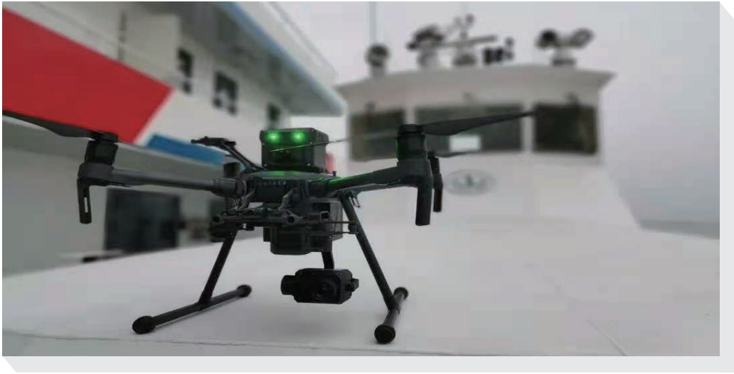
图 船舶尾气遥测无人机及机载嗅探设备
